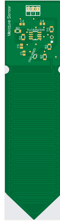
Fig. 2. Custom Moisture Sensor PCB
